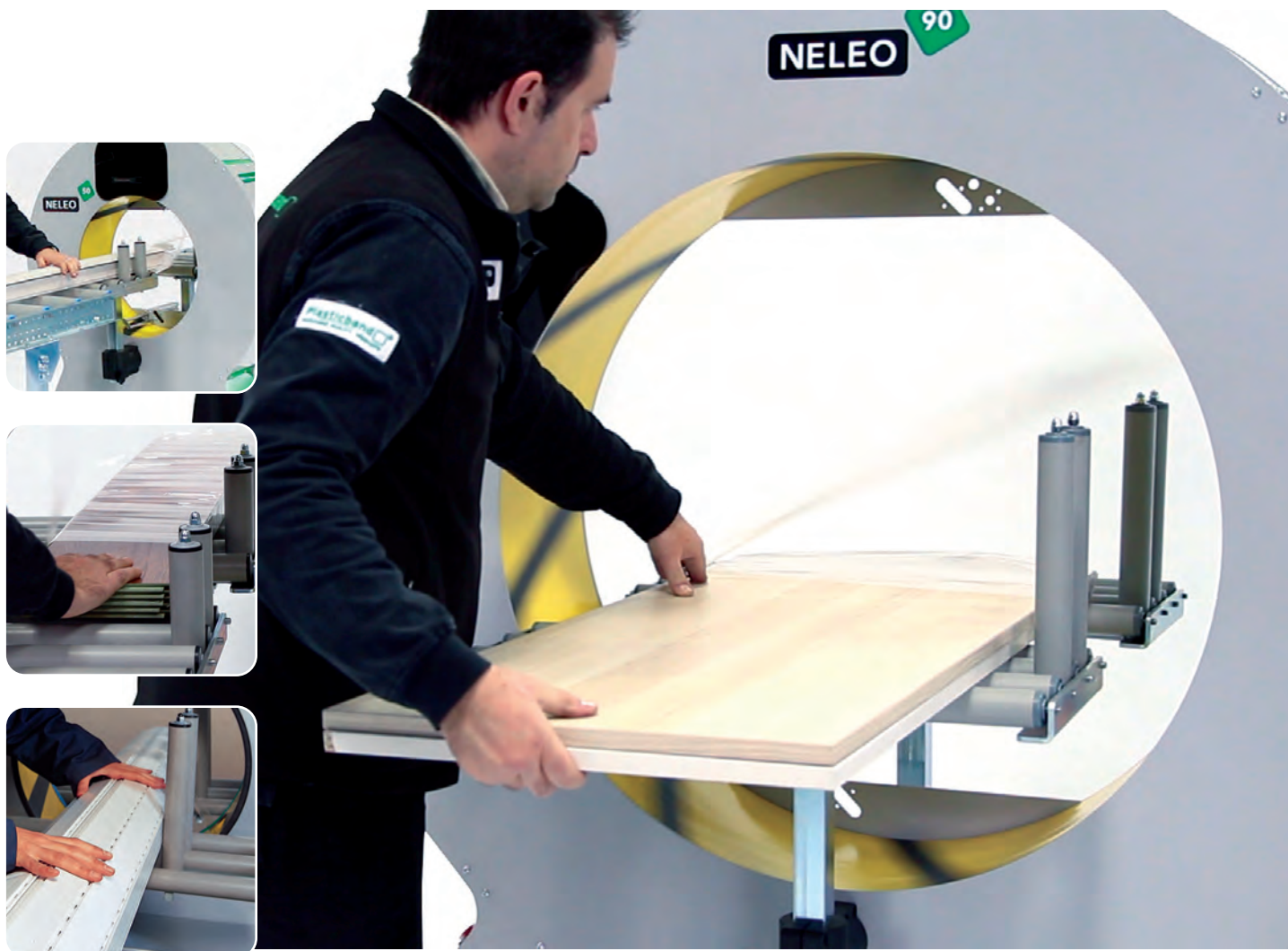
Automatische Schnitt & Festgemacht Taglio e preparazione automatica автоматический выключатель и зажимное устройство
